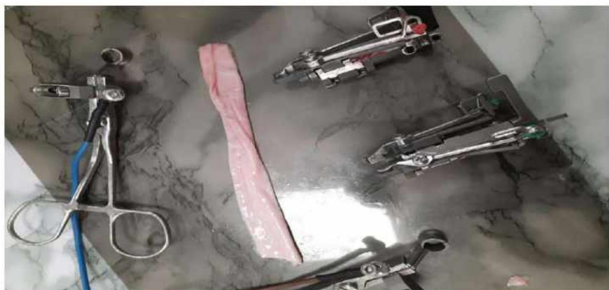
Рисунок 1.3.1. Вигляд вени відпрепарованої, підготовленої до випробування
