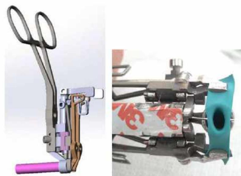
5. *Крок четвертий:* а – дві частини інструмента разом без судин; б – з розбортованими і готовими до зварювання кінцями судини; в – процес зварювання.
