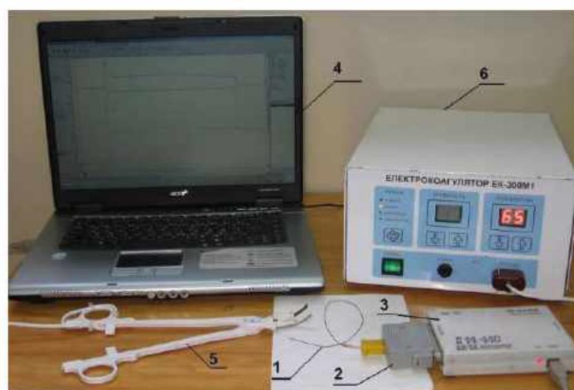
Рисунок 1.1.3. Загальний вигляд системи вимірювання температури при біополярному високочастотному електрозварюванні м'яких біологічних тканин
