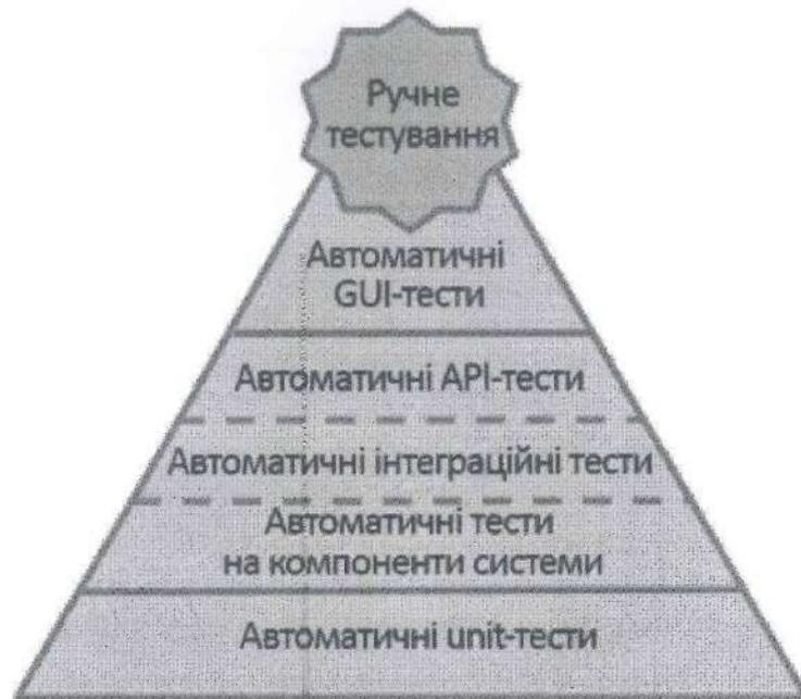
Рис. 4. Піраміда ідеального тестування
