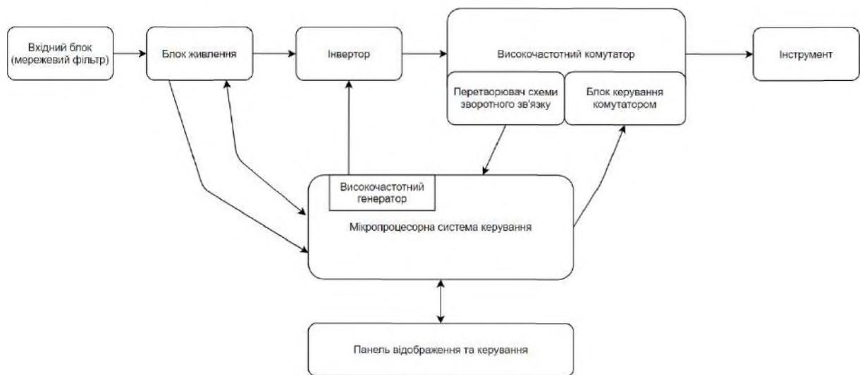
Рис. 2.1.1 Структурна схема джерела живлення
